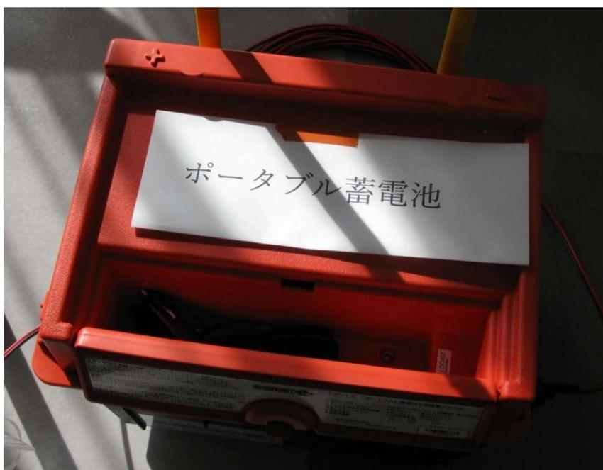
ソーラーパネルの写真下にある青色の箱は USB 端子で(電圧が合えば)直接繋げることができます。ポータブル蓄電池はソーラーパネルでできた電気を蓄えるための専用の蓄電池です。室内(複合施設会議室)だったので、残念ながら発電効率や蓄電能力のチェックはできませんでした。これらのセットも今後虫干しの機会を与えないといけないかもしれません。
